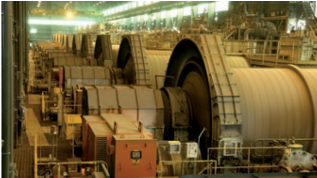
Codelco Teniente Tek Pinyonlu Bilyalı Değirmenler - LSS Motorlar (Yenileme)
