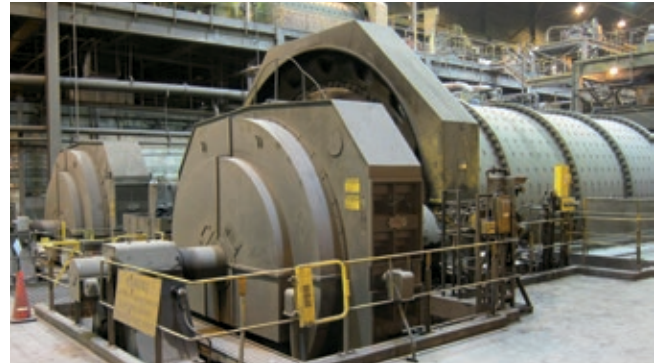
United Taconite LLC - Minnesota ABD Çift Dişli SAG Değirmeni - 2x DSS Motor + Hava Debriyajlı Yük Paylaşım Sistemi
