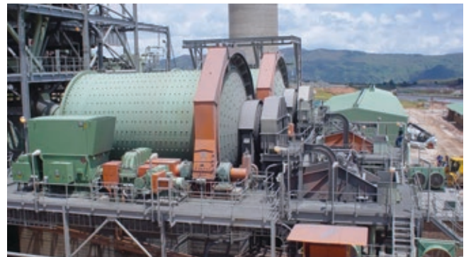
Everest South Platinum Mine Tek Dişli Değirmenler: Fırçalama kaldırma cihazıyla WRIM + Sıvı Reostat Başlatıcı
