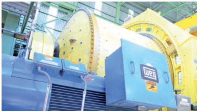
Potrerrillos Codelco Salvador - Şili Tek Dişli Bilyalı Değirmen - SCIM + MV VFD
